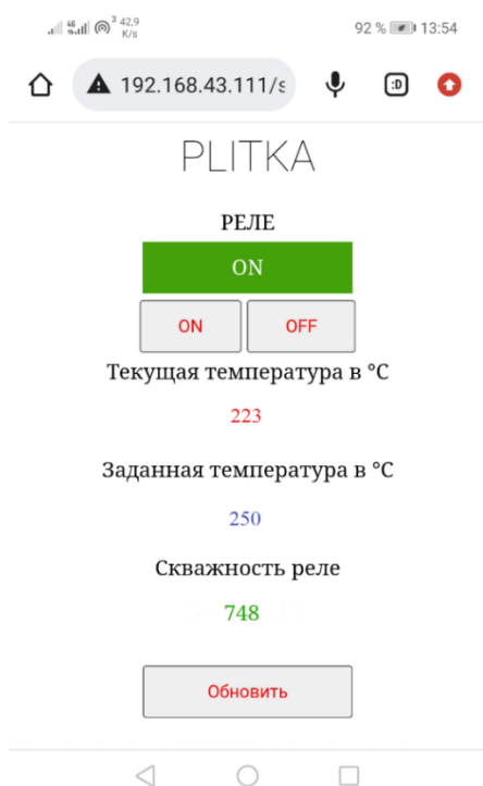
Рисунок 4. Экран мобильного приложения для управления работой лабораторной печи
