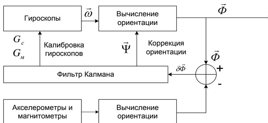
Рисунок 1 – схема комплексирования гироскопов, акселерометров и магнитометров.
